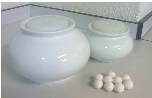
Jarras de alúmina diseñadas para molturación de materiales en molino rápido de laboratorio.
